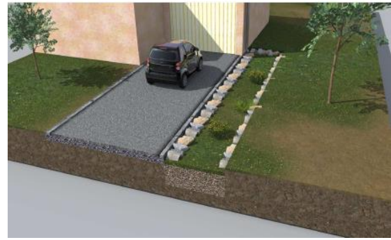
Espace d'infiltration à la parcelle (source : Grand Lyon)
